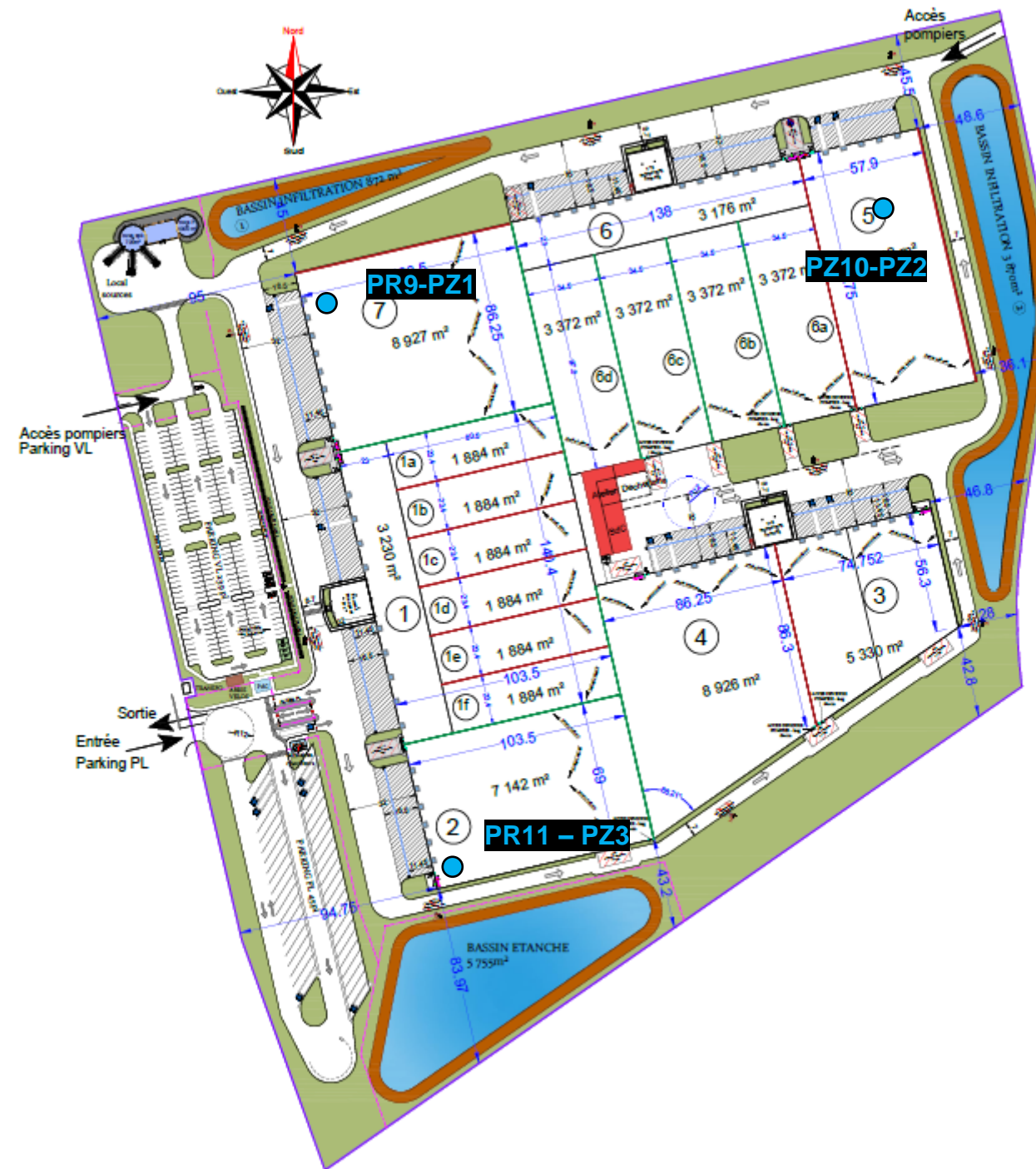
Figure 20 : Plan d'implantation des piézomètres
