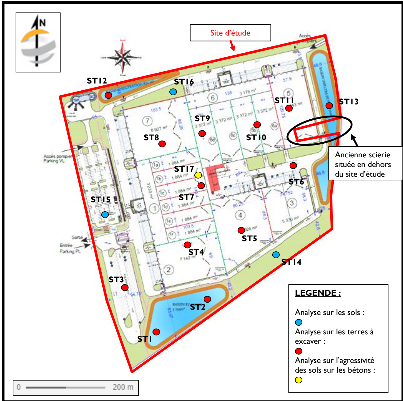
Figure 18 : Plan de sondages de sols réalisés au droit du site
